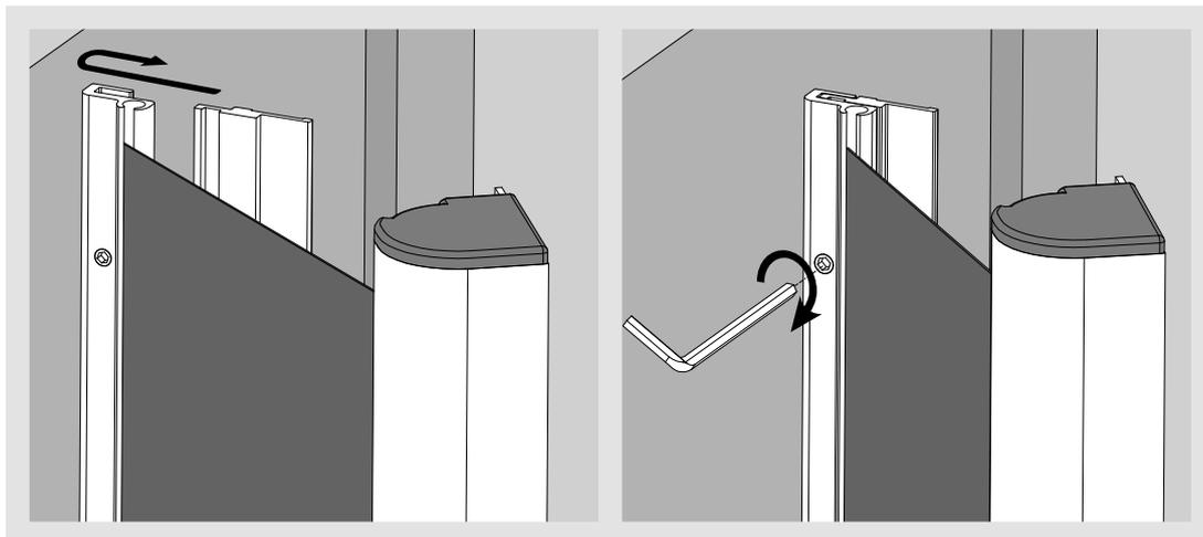
Avec le mécanisme d'accrochage développé par Planet, vous pouvez aisément accrocher le profil avec le tissu et le visser facilement avec une clé Allen. (FSR 6000 / FSR 7000)
