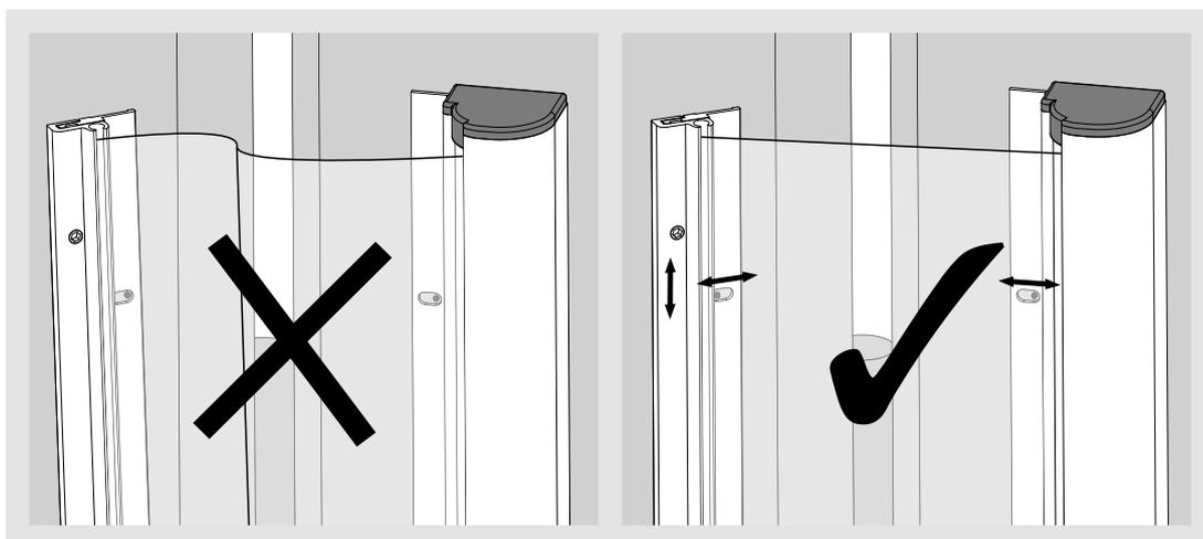
Le store du protège-doigts et le profil de montage peuvent être déplacés vers la gauche ou vers la droite. Le profil avec le tissu peut être également déplacé vers le haut ou vers le bas si nécessaire. (FSR 6000 / FSR 7000)
